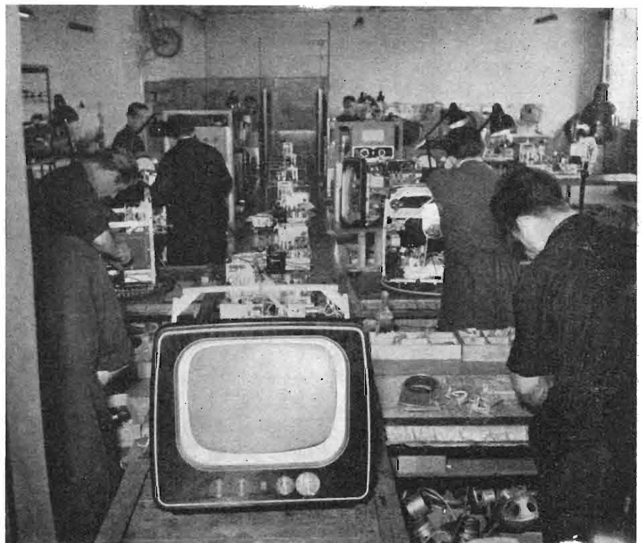
Due fasi della costruzione dei televisori Philips negli stabilimenti di Monza: il montaggio meccanico e quello elettrico.
